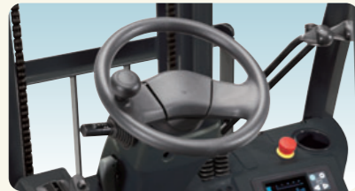
電動パワーステアリング(EPS)
