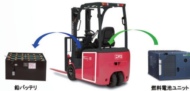
図1 燃料電池ユニットの置き換え
