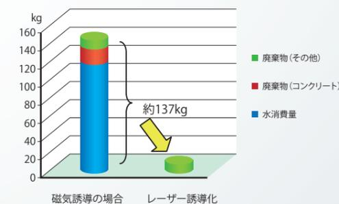
図1 水の消費量と廃棄物の削減(走行距離100m時)
