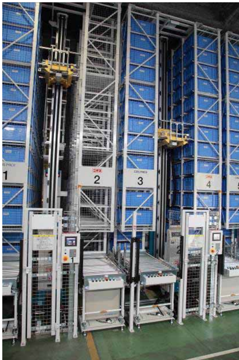
写真：自動倉庫 キャスパック・バケットタイプ 型式 CCB05-21-06
