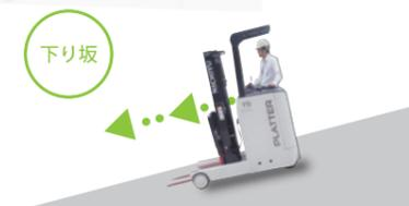
安全な一定速度を維持します。(降坂時抑速回生) 積載時の下りは、後退で走行してください。
