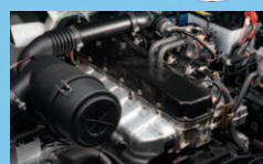
電子制御ガソリン/LPGエンジン(GK45)
