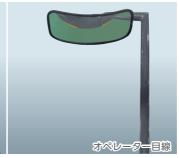
車体後部にアンダーミラーを標準装備。カウンターウェイト後方の死角を カバーする広角ミラーのため、見える範囲が広く、左右車幅を超えてコー ナー部分まで確認が可能です。
