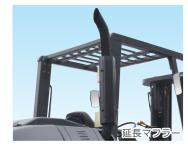
アップライトマフラーの位置を右 後方に配置し排気口を外側に向け ることで、後進時に排出ガスがオペ レーターにかかりにくい配置に改良 しました。さらに排気口の位置を 300mm延長と500mm延長の2 種類をオプションでご用意しまし
