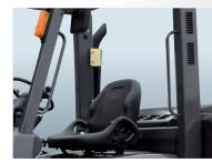
ヘッドガード左前方に設置され ていた手すりを、左後方にも新 設。乗降時に両手でつかめるの で、より乗り降りしやすくなりま
