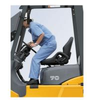
オペレーターが正しい運転操作位置に いる場合のみ、走行・荷役操作が可能に なる、インターロック機構を装備。オペ レーターの不安定な姿勢での作業や、 誤作動による事故を未然に防ぐための 安全装備です。
