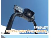
4つのカメラで車両の全周囲をモニ ターに映像化。状況変化や死角をリ アルタイムで確認し、安全作業を しっかりとサポートします。車両の 真上から見るような360度俯瞰 ビューのほか、前後進レバー操作に 応じて前方ビュー/後方ビューを自 動切替で運転席のモニターに表示 します。
