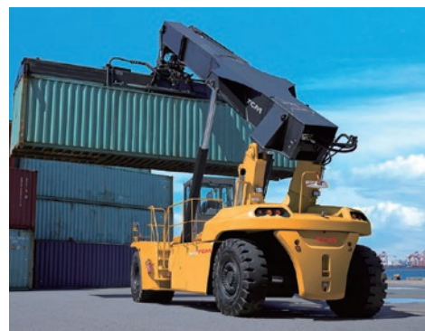
リーチスタッカー
