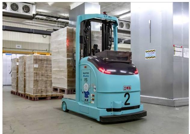
・冷凍倉庫内で稼働するレーザー誘導方式無人フォークリフト「PLATTER Auto」
