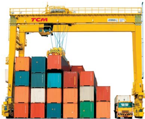
タイヤ式門型クレーン (RTG)
