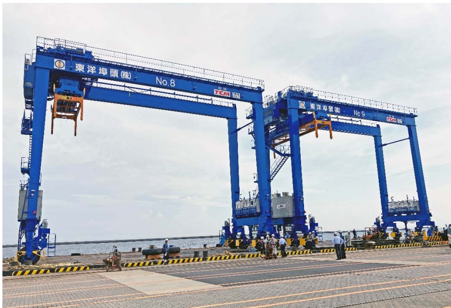
新型タイヤ式門型クレーン「F-ZERO」タイプ
